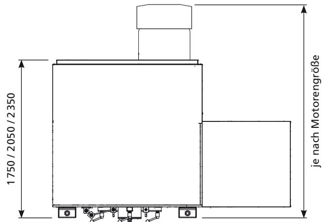
Abb. 13: Maschinenabmessungen (mm) einer S-XX18 in Rechtsauführung
