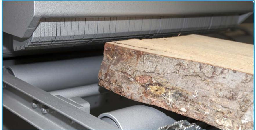
Abb. 9: Rückschlagsicherung für mehr Sicherheit
