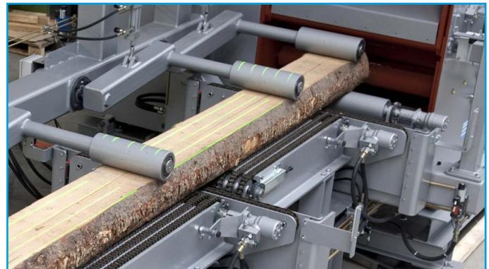
Abb. 16: Semiautomatische Beschickung
