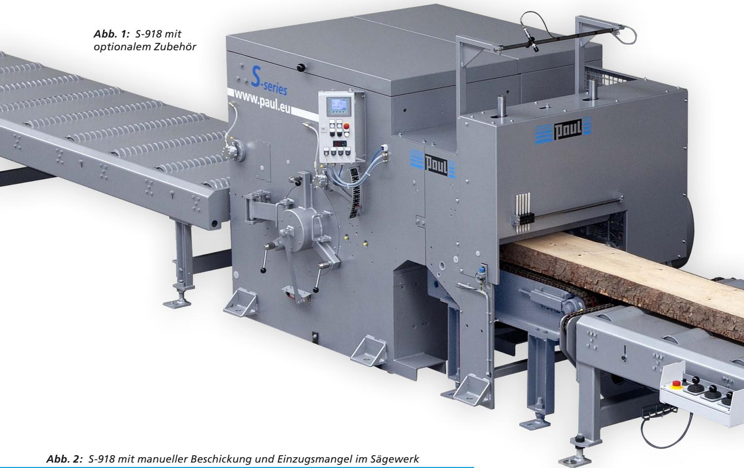
*Abb. 2: S-918 mit manueller Beschickung und Einzugs-mangel im Sägewerk*
