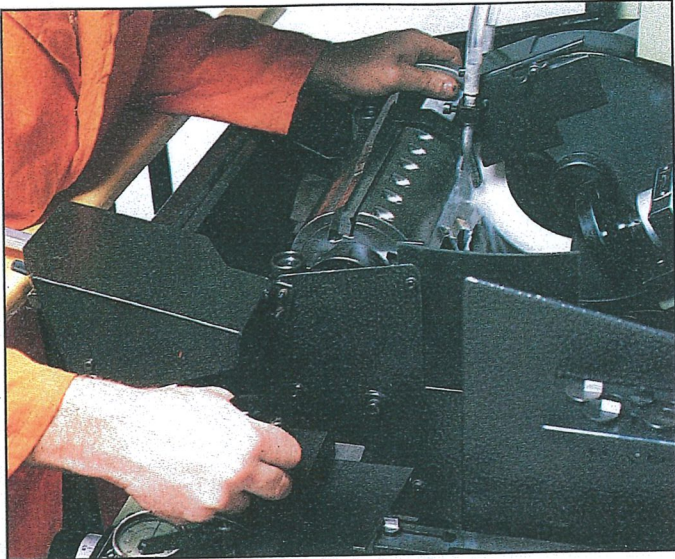
Müheloses Schleifen und absolute Genauigkeit durch den Kreuzsupport mit Rollenführungen (Modell 931).
