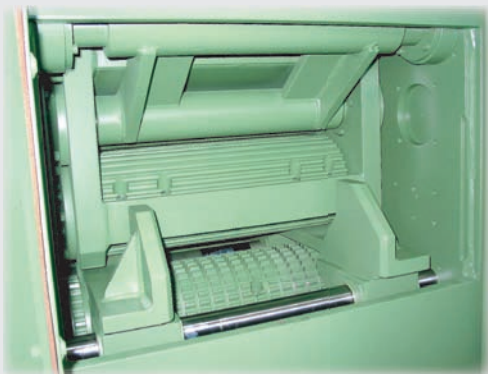
Holzführungseinheit auf der Einlaufseite der Maschine, einstellbar je nach Einschnittdimension mit Servozylindern und Lineargebern
