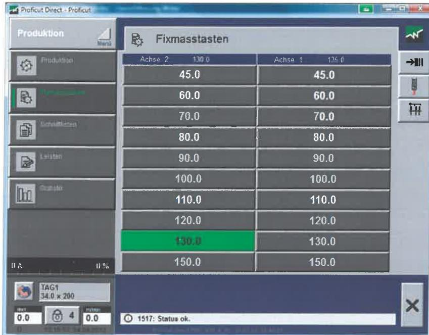
Für einen schnellen Überblick über das/die momentan angewählte(n) Fixmaß(e) werden die aktiven Schaltflächen zur Bestätigung grün hinterlegt. Das geschieht sowohl bei der Auswahl über das Touch-Panel als auch bei der Auswahl über die Fixmaßtasten unter dem Touch-Panel.
