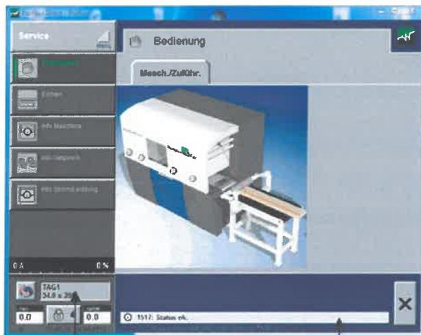
Die Menüführung eines jeden Bildes ist bis auf wenige Ausnahmen gleich. Auf der linken Seite ist die Menüleiste untergebracht.
