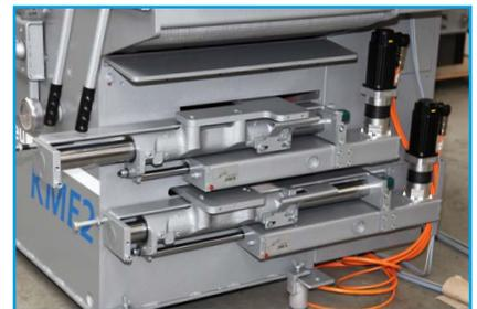
Abb. 22: servomotorische Sägeblattverstellung
