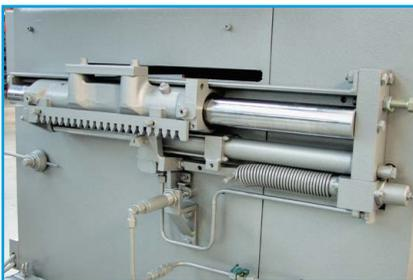
Abb. 20: hydraulische Sägeblattverstellung
