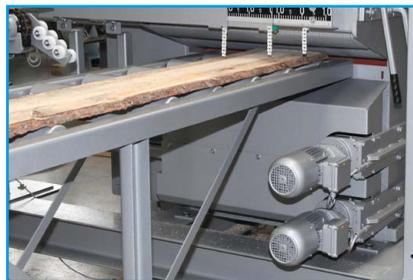
Abb. 21: elektrische Sägeblattverstellung
